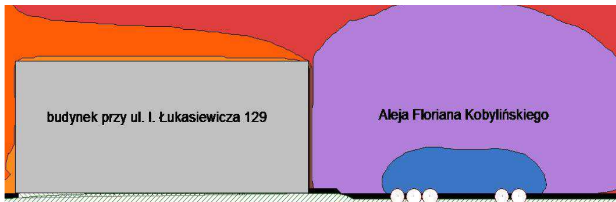
Rys. 12.2 Obliczony rozkład poziomu hałasu drogowego w płaszczyźnie pionowej na fasadzie budynku od Alei F. Kobylińskiego przy ul. I. Łukasiewicza 129.
